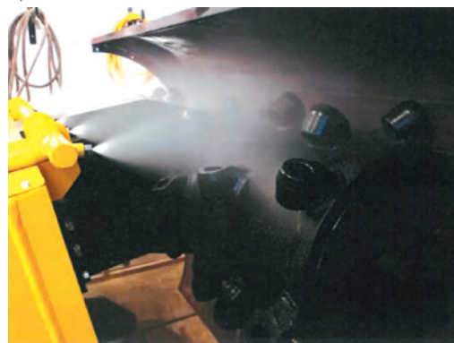
Rys. 5. Stanowisko badawcze układu zraszania: a) próby badawcze; b) działanie układu zraszania
