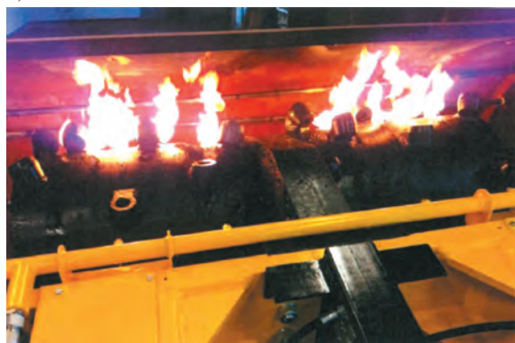
Rys. 5. Stanowisko badawcze układu zraszania: a) próby badawcze; b) działanie układu zraszania
