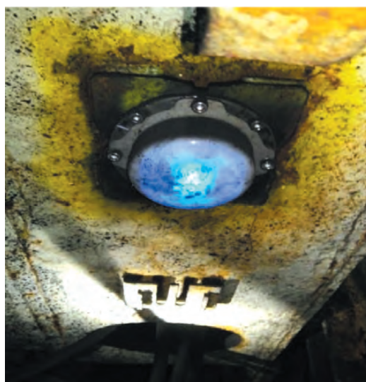
Rys. 8. Montaż czujnika w warunkach rzeczywistych z wykorzystaniem uchwytów
