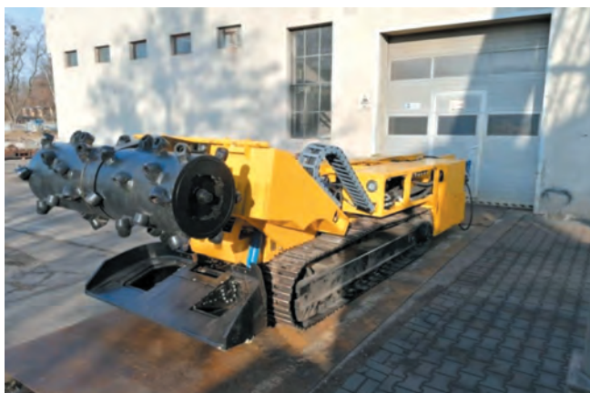
Rys. 8. Prototyp frezarki spągowej Hydroma
