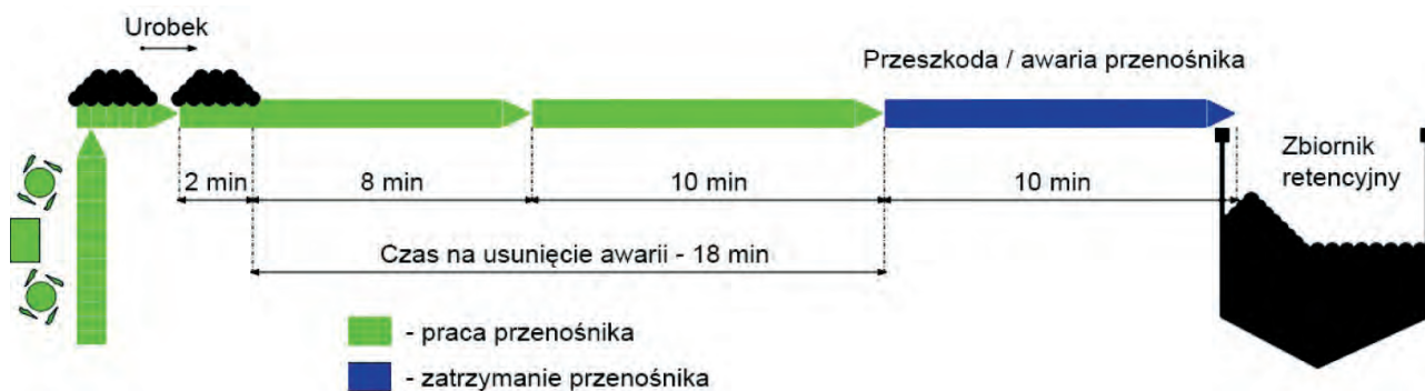
Rys. 2. Idea sterowania odstawą urobku w automatycznym trybie „inteligentnym”
