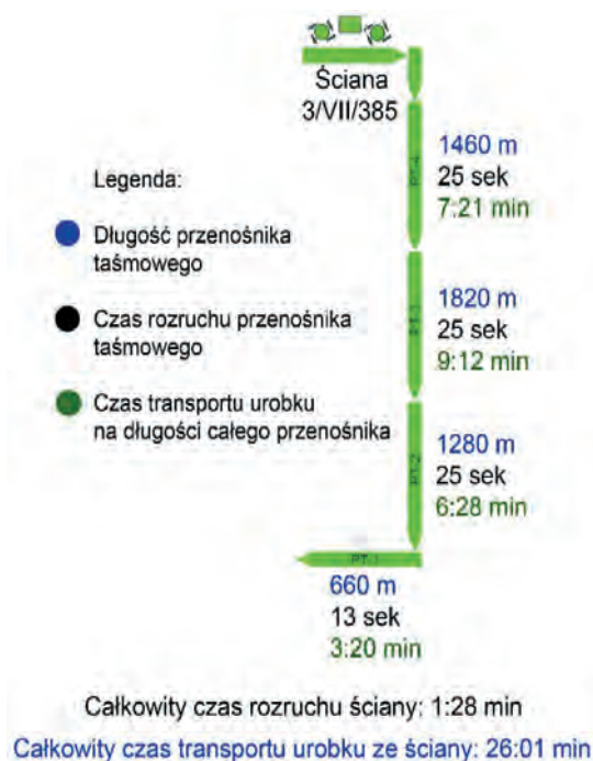
Rys. 1. Analiza kluczowych czasów pracy odstawy urobku
