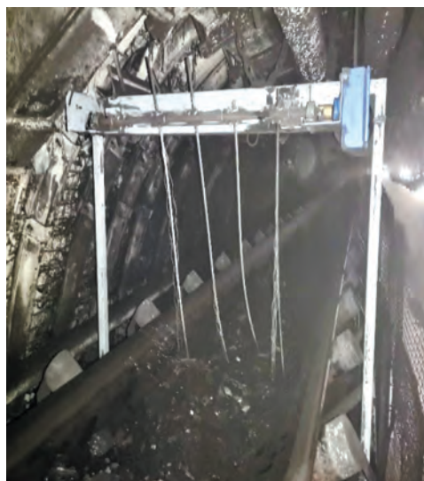
Rys. 3. Czujnik obecności urobku
