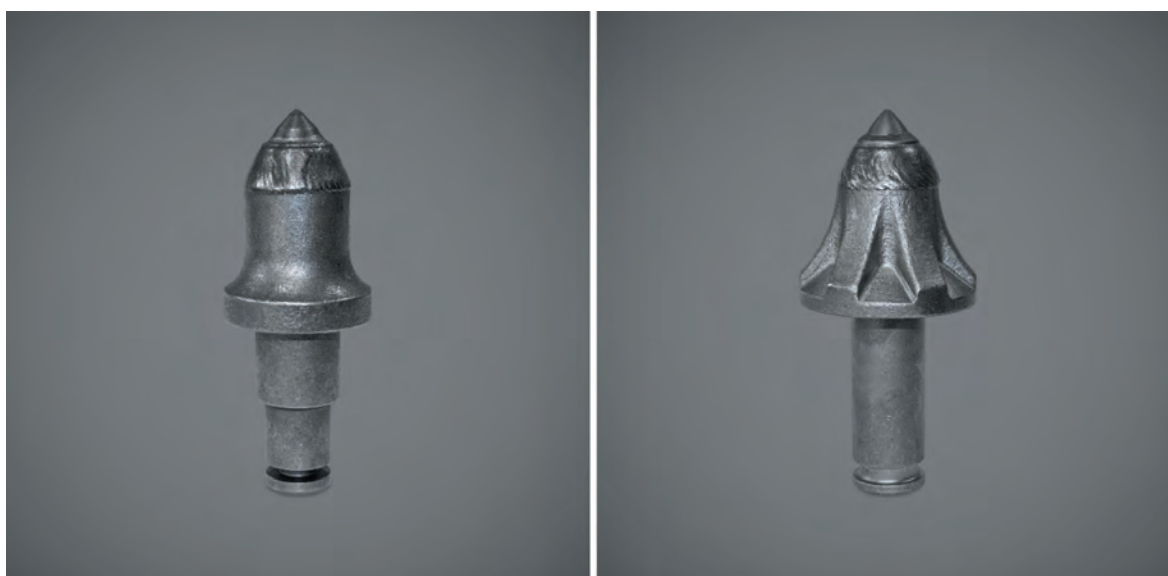
Rys. 5. Przykładowe noże firmy Betek z warstwą ochronną na części roboczej [2]
