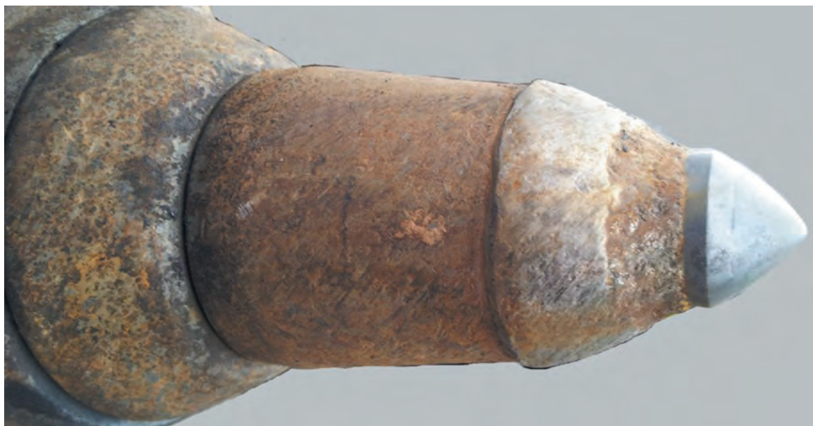
Rys. 4. Nieprawidłowe dobranie wielkości wkładki z węglików spiekanych do twardości korpusu oraz do warunków górniczych
