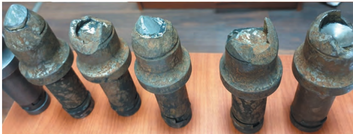
Rys. 2. Noże po jednej dobie urabiania nieznannej konkurencyjnej firmy
