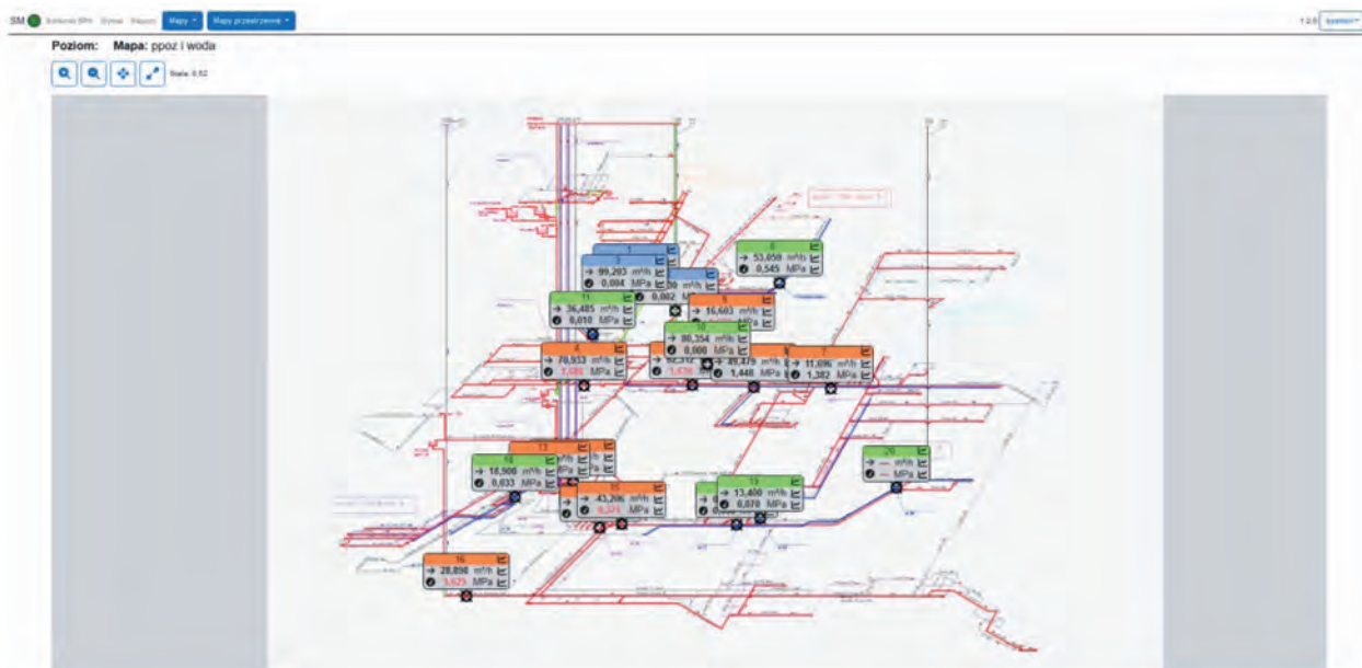
Rys. 3. Widok podstawowego ekranu synoptycznego aplikacji wizualizacyjnej systemu SYSMON ze wskazaniem sumarycznymi przepływomierzy w KWK Piast-Ziemowit Ruch Ziemowit
