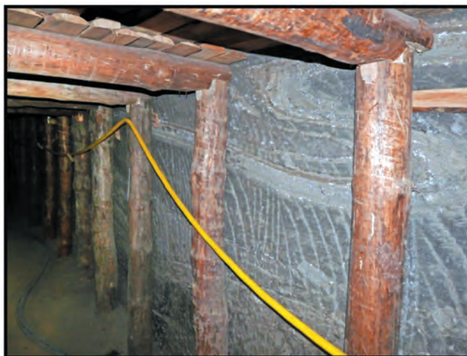
Rys. 2. Podłużnia Baum. Rejon planowanego szybiku. Odslonięcie soli spizowych z przerostami iłowców anhydrytowych. Stan na lipiec 2017 r. [4]
