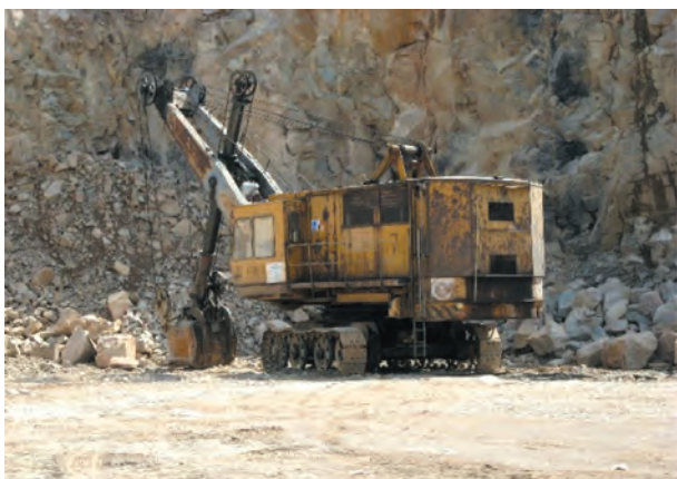
Rys. 9. Jednonaczyniowa linowo-elektryczna koparka przedsiębiorna Skoda E-303
