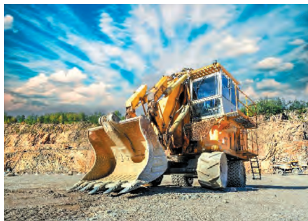
Rys. 11. Jednonaczyniowa hydrauliczna koparka przedsiębiorna Bola LB-600
