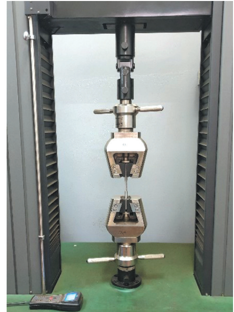
Rys. 6. Badanie spektrometrem składu chemicznego elementów konstrukcji (a); maszyna wytrzymałościowa do zrywania próbek metalu (b)
