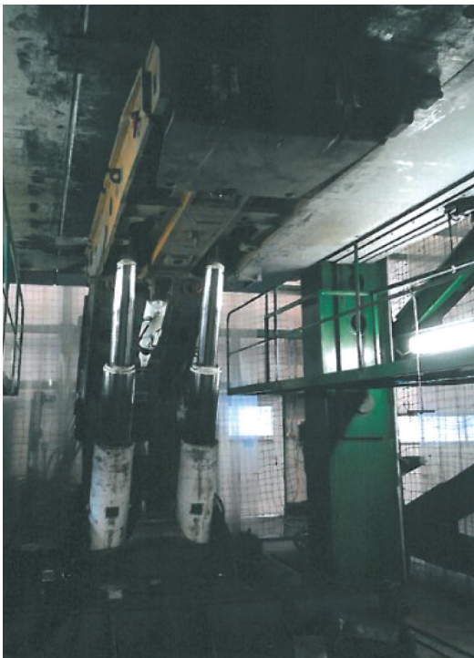
Rys. 9. Prototyp obudowy ZRP-15/35-POz na stanowisku badawczym TLO Opawa (a); certyfikat potwierdzający pozytywny wynik badań typu WE (b)
