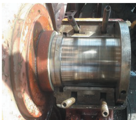
Rys. 8. Rysy obwodowe na powierzchni czopa łożyskowego osi
