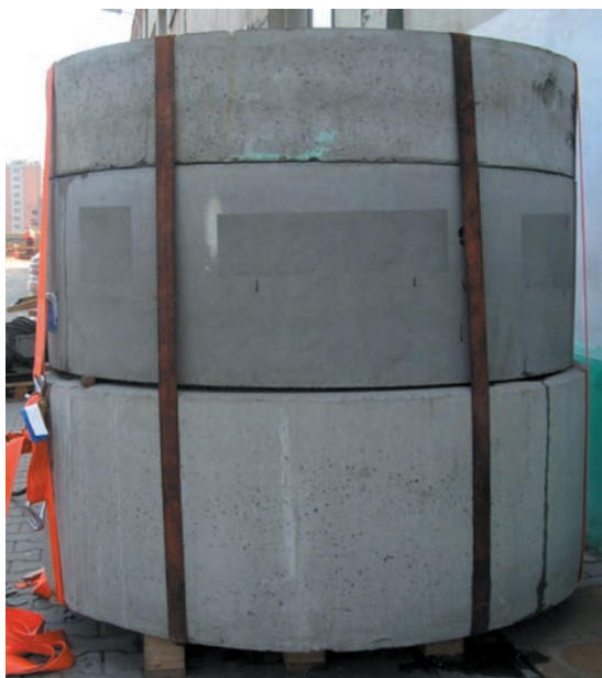
Rys. 8. Studzienka betonowa podczas badania
