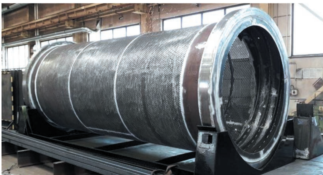
Rys. 6. Konstrukcja przesiewacza bębnowego [3]
