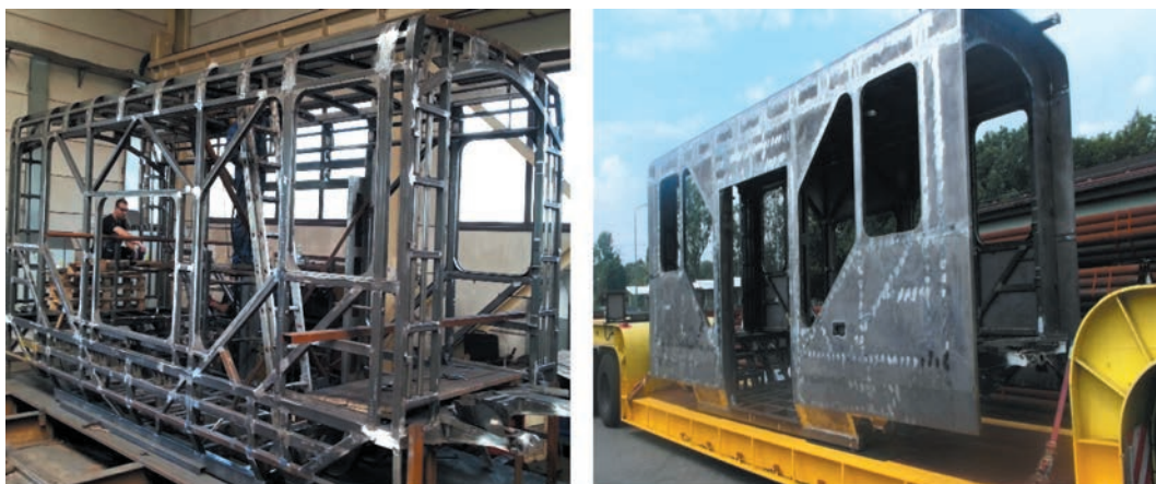
Rys. 5. Konstrukcja członu środkowego tramwaju [3]
