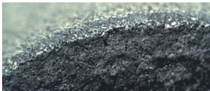
Rys. 4. Zużyta krawędź narzędzia po testach na piaskowcu z Wogezów
