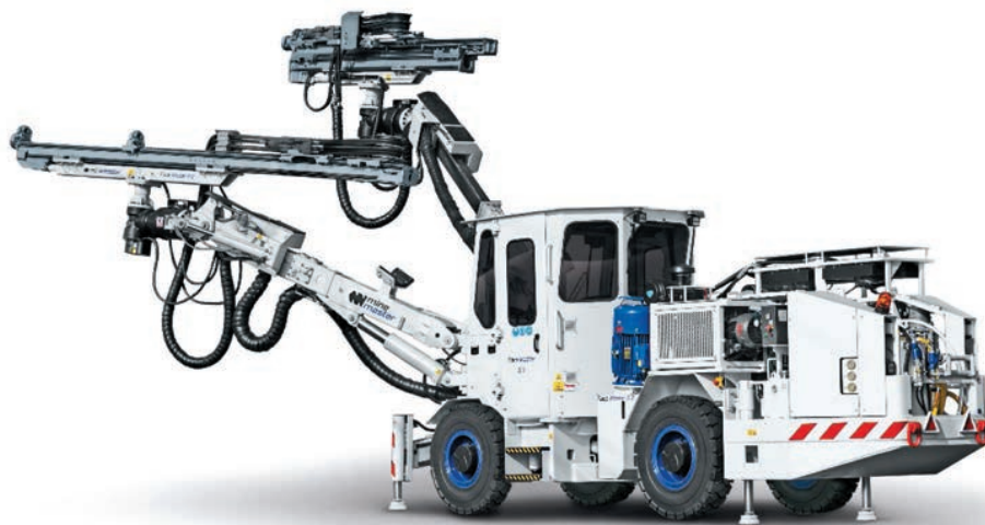
Rys. 3. Face Master 2.3 – dwuwysięgnikowy wóz wierzący
