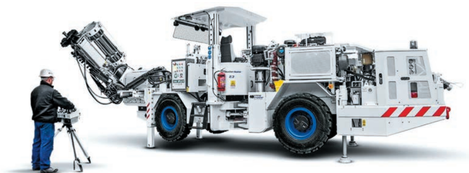
Rys. 5. Production Master 2.3 – wóz do wiercenia długich otworów
