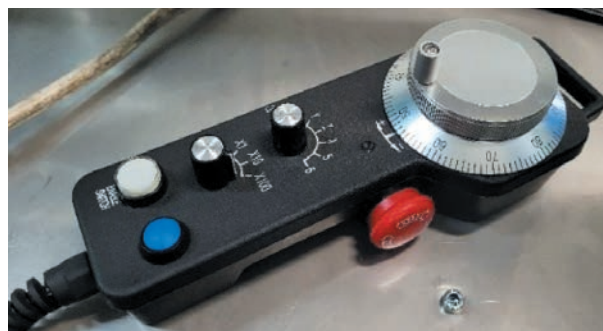
Rys. 6. Pilot MPG do opracowywania kodów G-code
