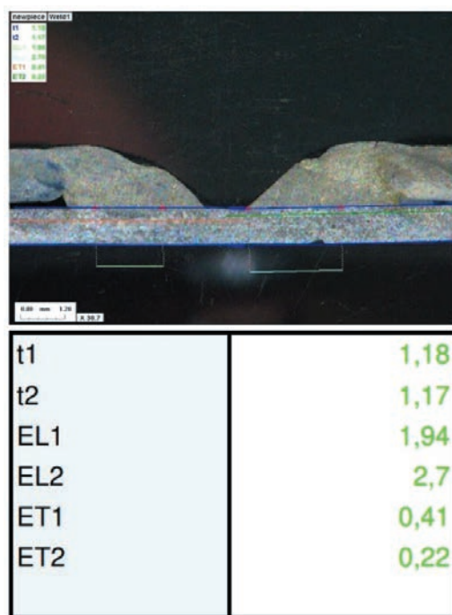
Rys. 8. Fragment raportu z metalograficznego badania zgładów (t1, t2 – grubość materiału bazowego; EL1, EL2 – długości wtopienia w osi cięcia; ET1, ET2 – głębokość wtopienia)
