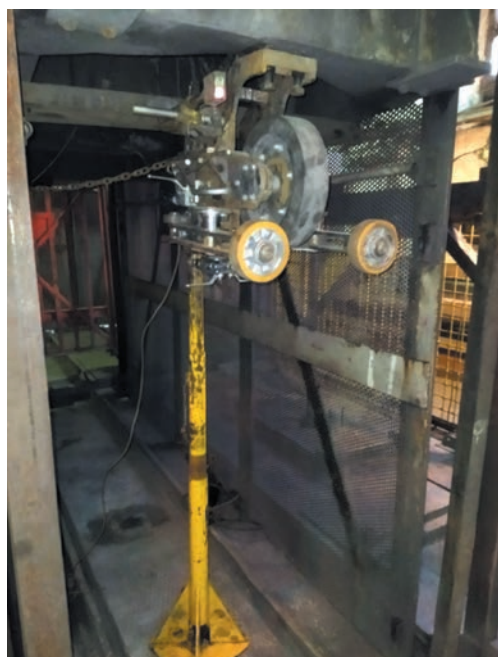
Rys. 2. Konstrukcja urządzenia pomiarowego zabudowanego w naczyniu wyciągowym
