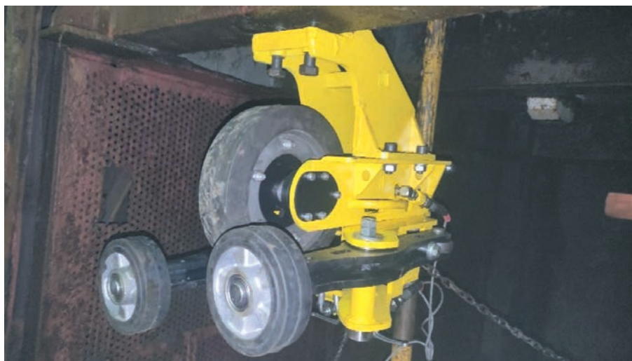
Rys. 3. Sposób mocowania dynamometru OPA-B-2018 pod głowicą naczynia wyciągowego
