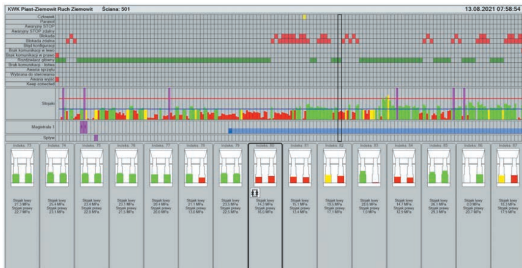
Rys. 5. Stan podporności w ścianie 501 bez zastosowanego aktywnego systemu
