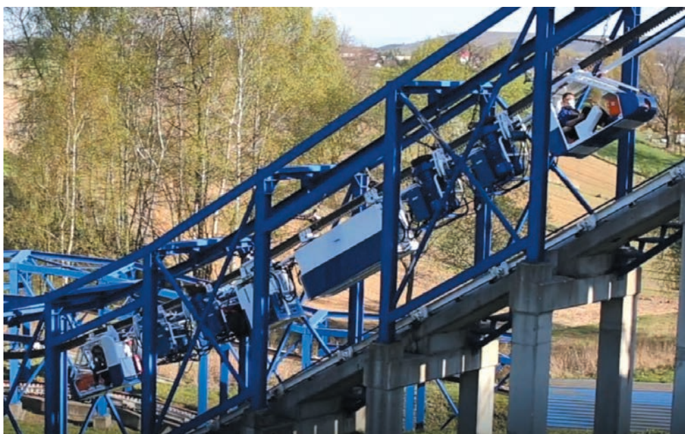
Rys. 6. Podstawowa konfiguracja ciągnika CA-190/4/2/2 na torze prób – nachylenie trasy 30 stopni
