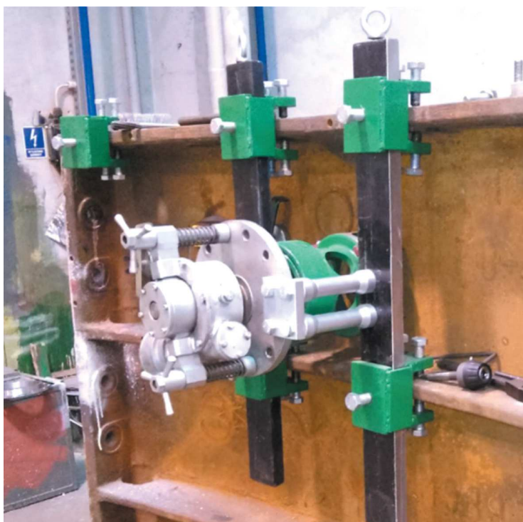
Rys. 4. Frezarka zamocowana do tubinga
