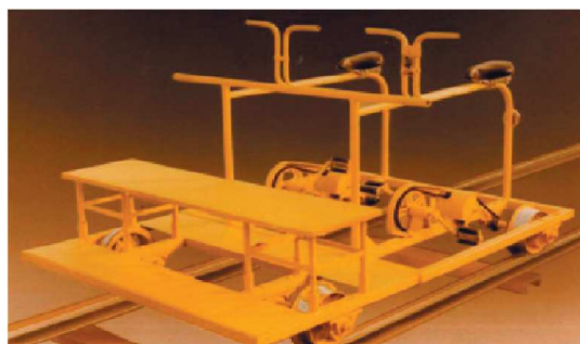
Rys. 8. Pięcioosobowy rower ratowniczy Zg-Nr. S-135016 [6]
