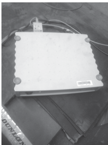
Rys. 3. Wzmacniacz pomiarowy HBM SPIDER8 przygotowany do badań
