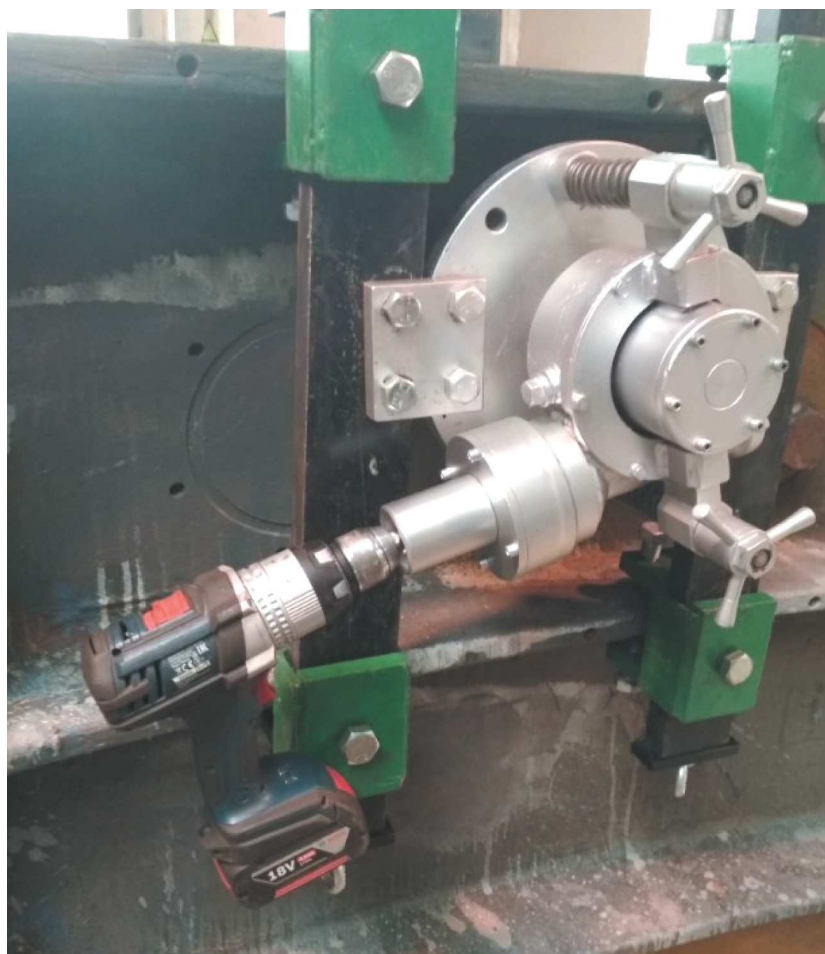
Rys. 10. Frezarka zamocowana do obudowy tubingowej wraz z wiertarkowkrętarą przekazującą napęd
