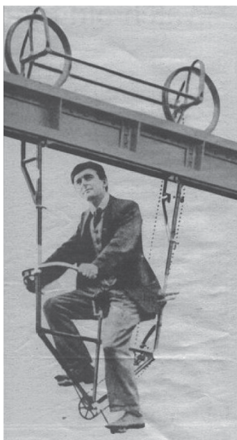
Rys. 2. Zawieszony rower jednoszynowy [4]
