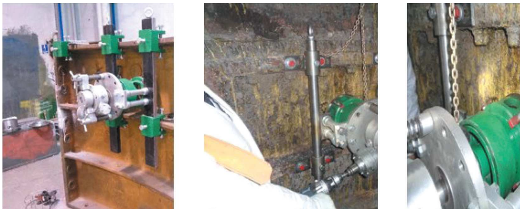
Rys. 9. Frezarka podczas prób wykonywanych na powierzchni
