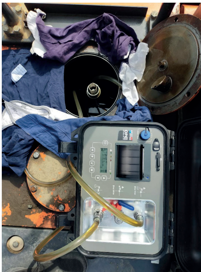
Rys. 2. Pobieranie oleju hydraulicznego bezpośrednio ze zbiornika koparki Doosan 380 LC-5
