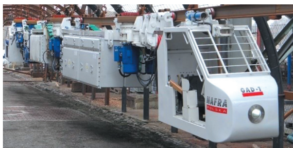
Rys. 12. Podwieszony ciągnik akumulatorowy GAD-1: a) na stanowisku producenta; b) w wyrobisku podziemnym [8]
