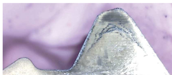
Rys. 11. Zdjęcie z części ostrza noża. Ten sam nóż jest z pełnym profilem krawędzi tylko po zakończeniu stosowania w obrabiarce (kształt IV, wykonywane przy powiększeniu 20×)
