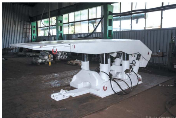
Rys. 6. Widok prototypu sekcji obudowy nowego typu
