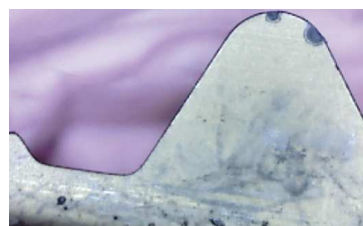
Rys. 10. Zdjęcie z części ostrza noża (wykonywane przy powiększeniu 20×)
