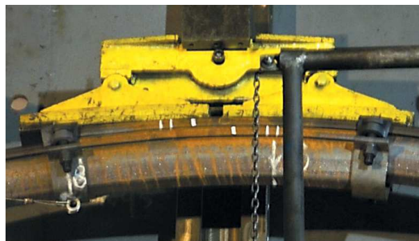
Rys. 13. Widoczny obrót elementu przenoszącego obciążenie główne
