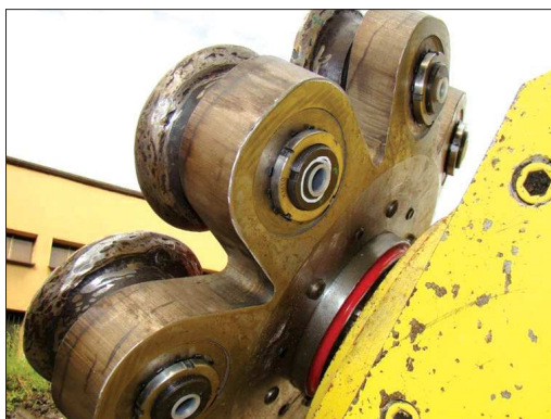
Rys. 6. Widok: a) zmodyfikowanego rozwiązania tarczy z narzędziami dyskowymi mocowanymi pod kątem -5^\circ ; b) nowego uniwersalnego rozwiązania tarczy z narzędziami dyskowymi mocowanymi w wymiennych uchwytach pod kątem 90^\circ [2]
