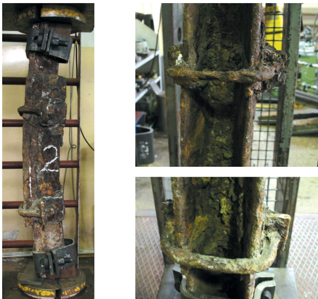
Rys. 4. Złącze cierne 2 przygotowane do badań i stan techniczny strzemion
