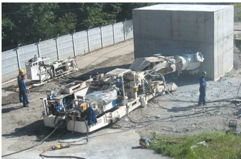
Rys. 8. Widok głowicy urabiającej z narzędziami dyskowymi zamontowanej na kombajnie FR 250 podczas prób poligonowych
