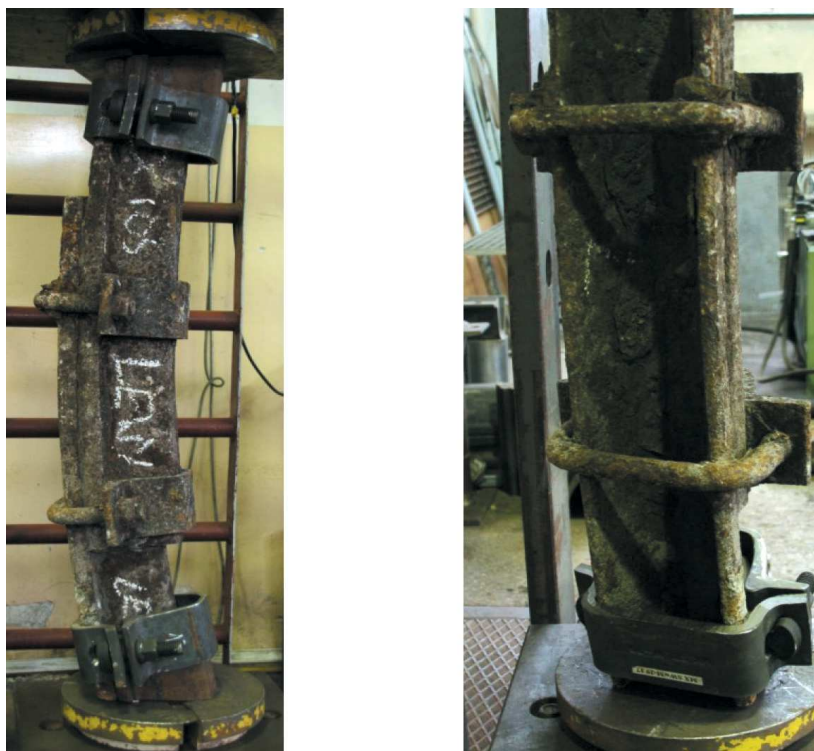
Rys. 3. Złącze cierne 1 przygotowane do badań i stan techniczny strzemion
