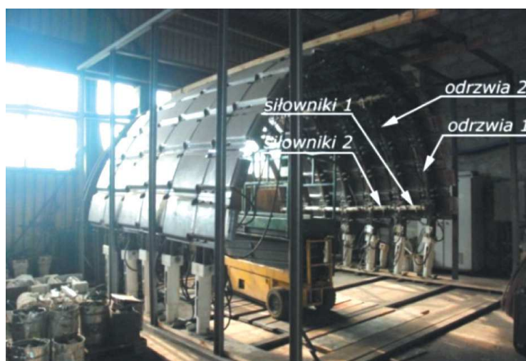
Rys. 10. Widok prototypu tymczasowej zmechanizowanej obudowy chodnikowej przed próbami stanowiskowymi
