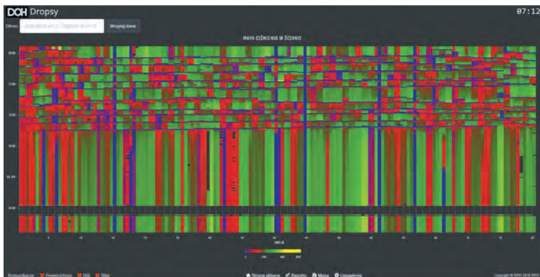
Rys. 10. Mapa rozkładu ciśnienia sekcji zmechanizowanej obudowy ścianowej
