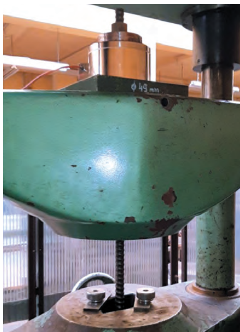
Rys. 12. Żerdź kotwi zamocowana w pulsacyjnej maszynie wytrzymałościowej
