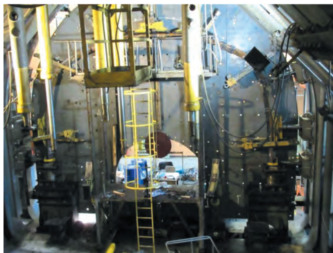
Rys. 12. Stanowisko badawcze z zainstalowanymi odrzwiami w trakcie badań
