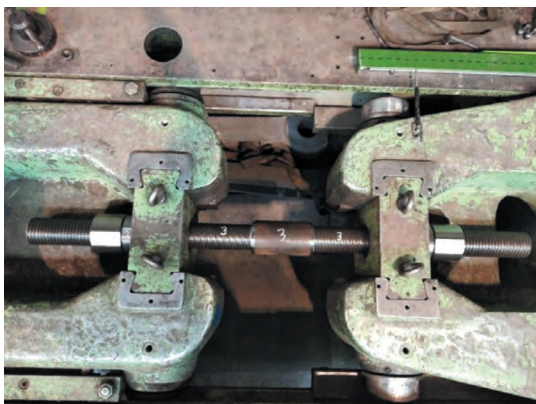
Rys. 9. Badanie wytrzymałości na rozciąganie żerdzi z łącznikiem w maszynie wytrzymałościowej o zakresie 5000 kN
