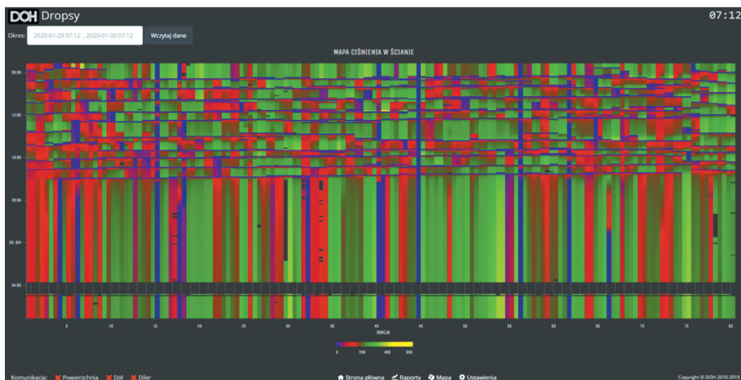
Rys. 10. Mapa rozkładu ciśnienia sekcji zmechanizowanej obudowy ścianowej
