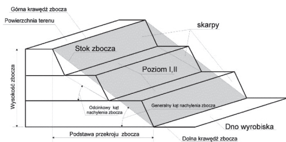
Rys. 4. Elementy budowy zbocza kopalni odkrywkowej
