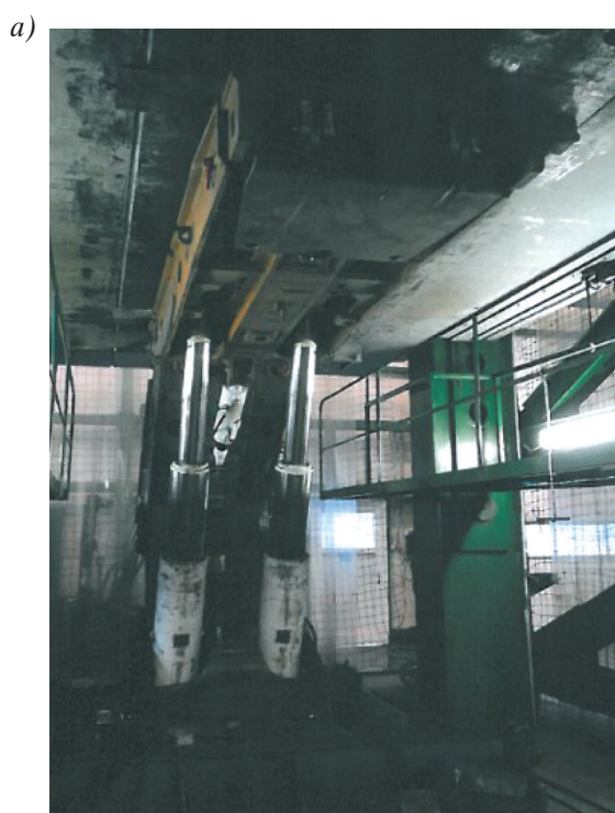
Rys. 9. Prototyp obudowy ZRP-15/35-POz na stanowisku badawczym TLO Opawa (a); certyfikat potwierdzający pozytywny wynik badań typu WE (b)
