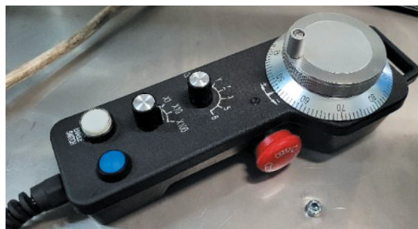
Rys. 6. Pilot MPG do opracowywania kodów G-code
