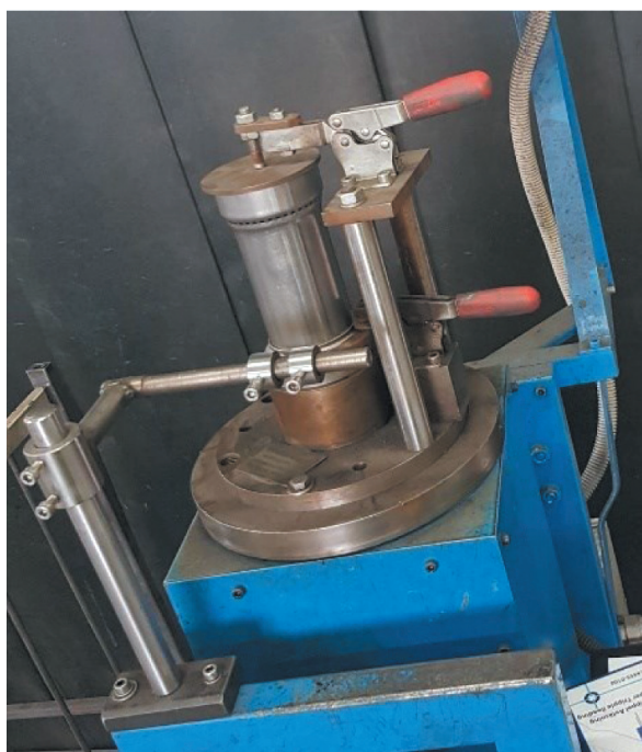
Rys. 2. Stanowisko obrotownika programowalnego (SOP)
