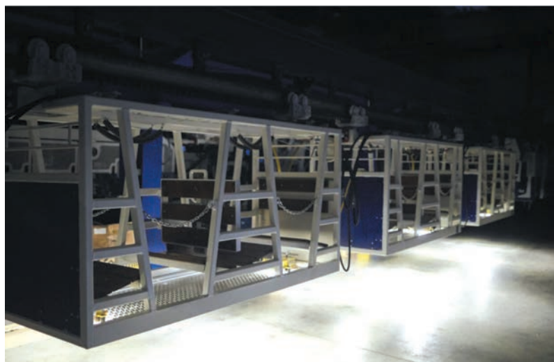
Rys. 4. Mobilne oświetlenie stacji osobowych z akumulatorowego ciągnika podwieszzonego typu CA-190 (białe światło – ciągnik znajduje się na stacji osobowej)
