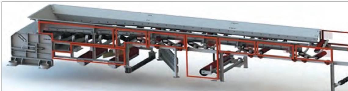
Rys. 3. Przykład rozmieszczenia osłon miejsc niebezpiecznych (pozycje czerwone)
