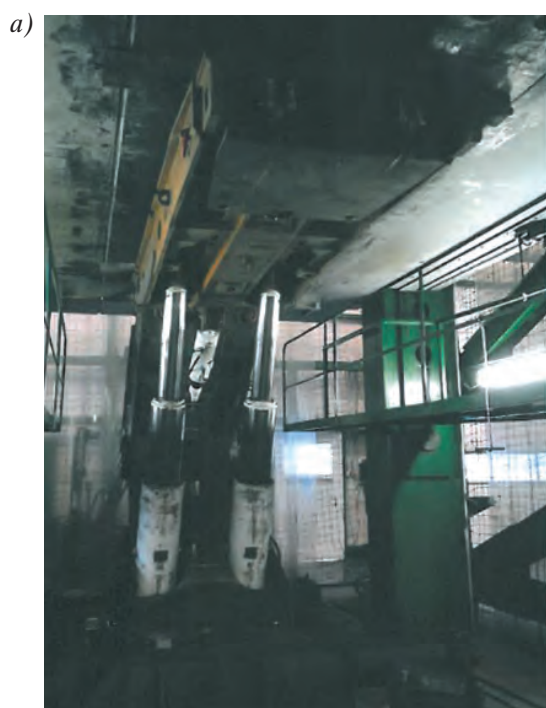
Rys. 9. Prototyp obudowy ZRP-15/35-POz na stanowisku badawczym TLO Opava (a); certyfikat potwierdzający pozytywny wynik badań typu WE (b)
