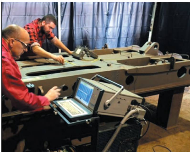
Rys. 6. Badanie spektrometrem składu chemicznego elementów konstrukcji (a); maszyna wytrzymałościowa do zrywania próbek metalu (b)
