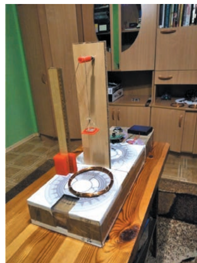
Rys. 9. Stanowisko pomiarowe dla monety
